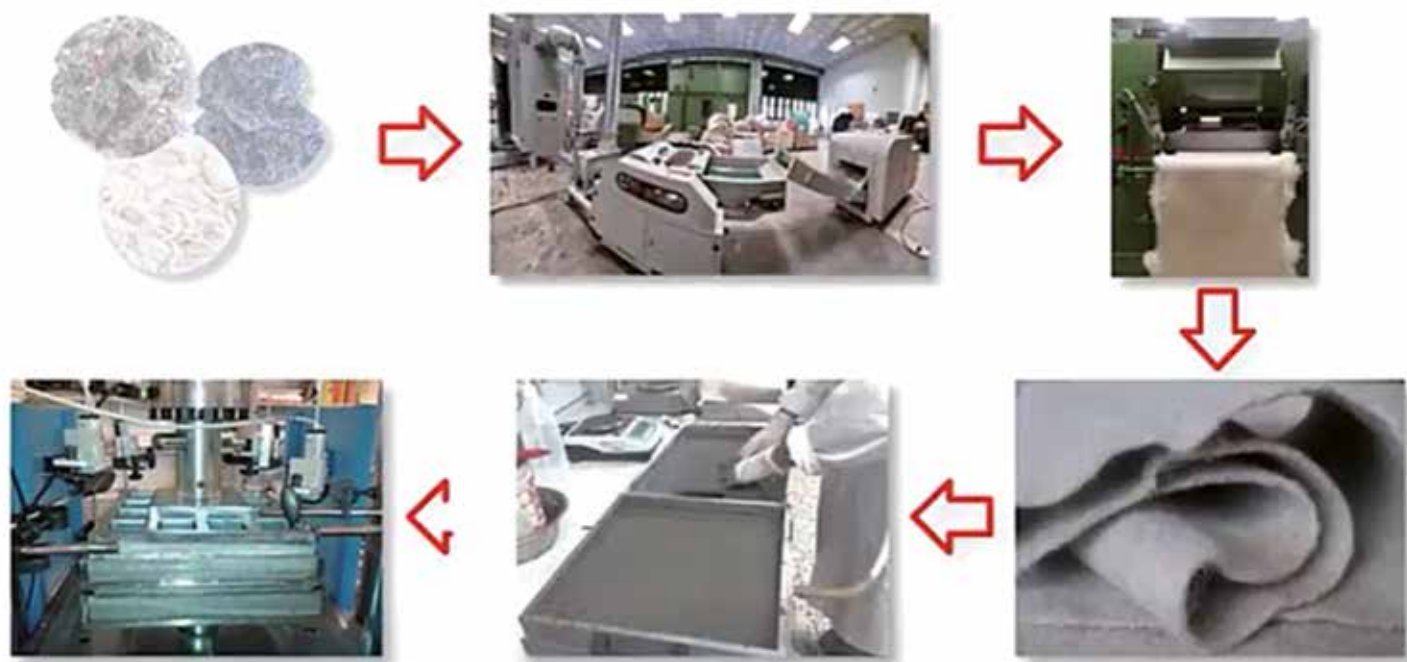
Proceso de producción del nuevo material de construcción a partir de residuos textiles
