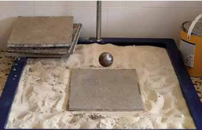
Prueba de resistencia al impacto por caída del nuevo material
