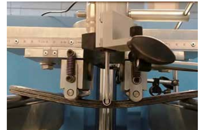
Medición de resistencia y flexibilidad del material
