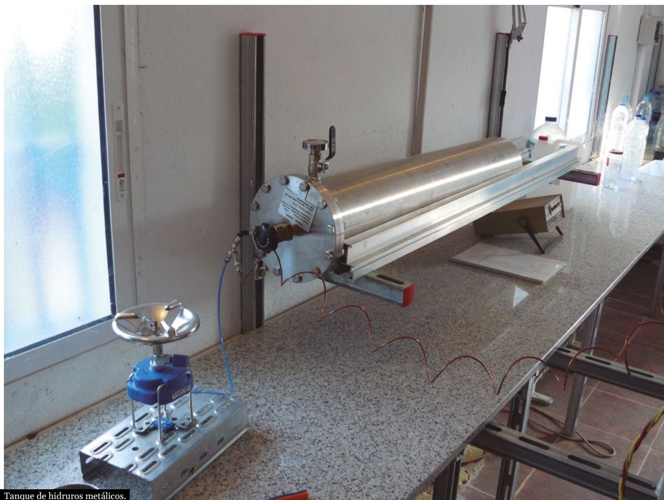
Tanque de hidruros metálicos.
