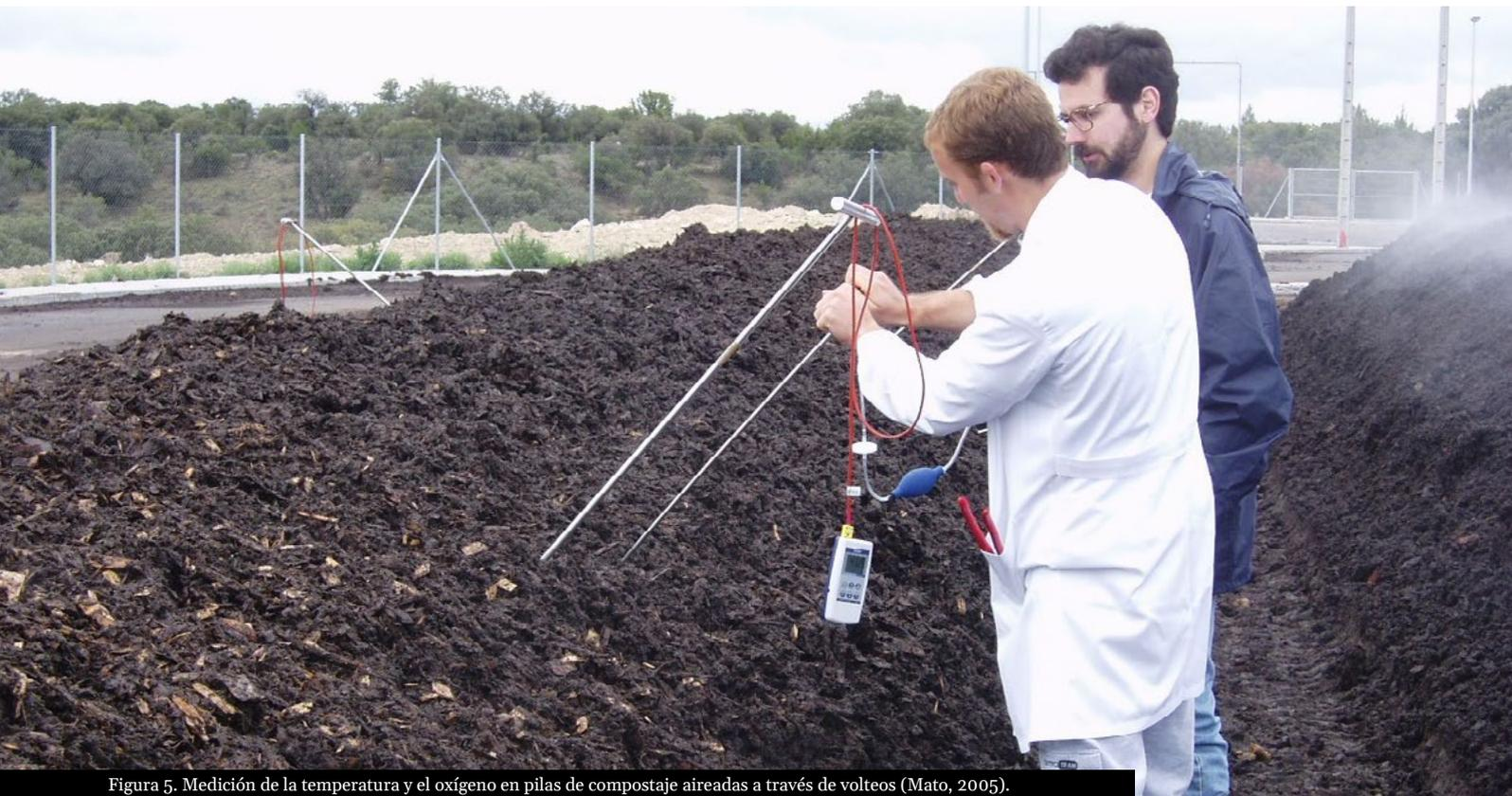
Figura 5. Medición de la temperatura y el oxígeno en pilas de compostaje aireadas a través de volteos (Mato, 2005).
