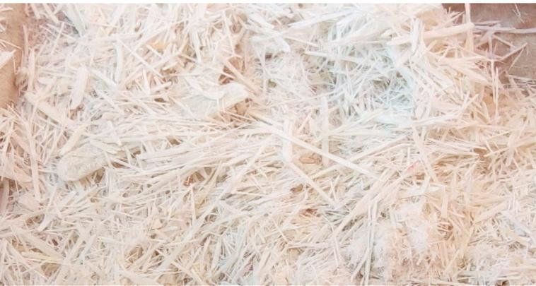
Foto 3. Proceso de reciclado mecánico de palas de aerogenerador. Obtención de fibras de vidrio de tamaño menor de 2 cm.
