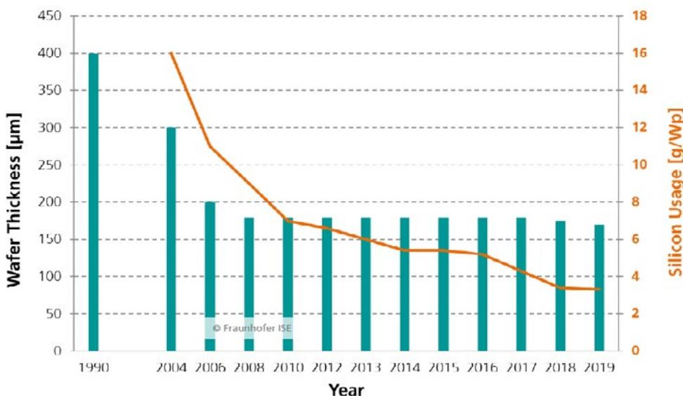
Figura 2. Reducción del uso de materiales en un panel fotovoltaico de silicio. Fuente: Fraunhofer.
