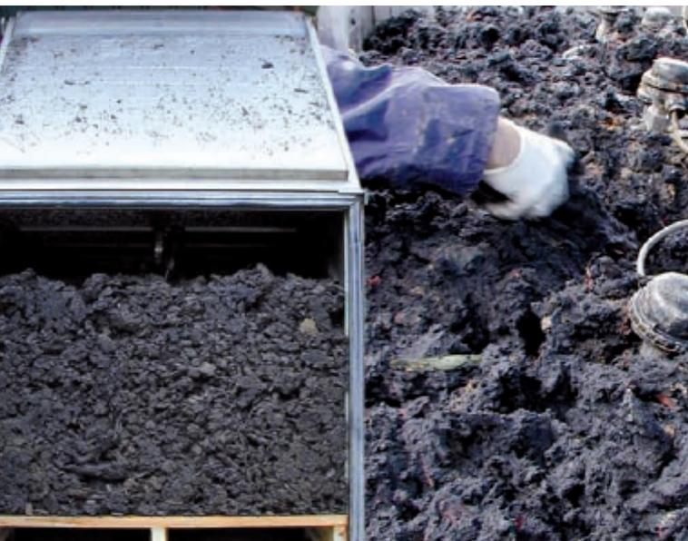
Figura 12. Biorreactor de residuos orgánicos (BIORESOR) del Equipo de Biotecnología Ambiental de la Universidad de Vigo (Patente 009900981).
