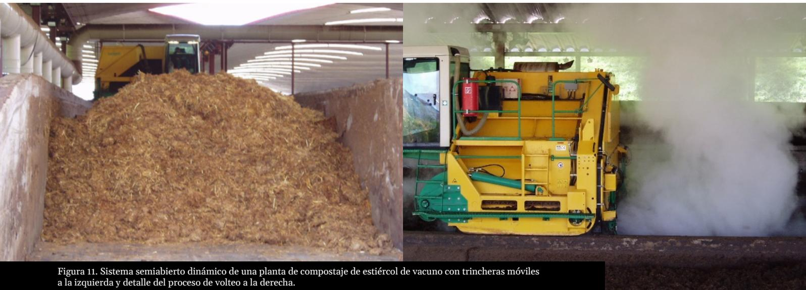
Figura 11. Sistema semiabierto dinámico de una planta de compostaje de estiércol de vacuno con trincheras móviles a la izquierda y detalle del proceso de volteo a la derecha.
